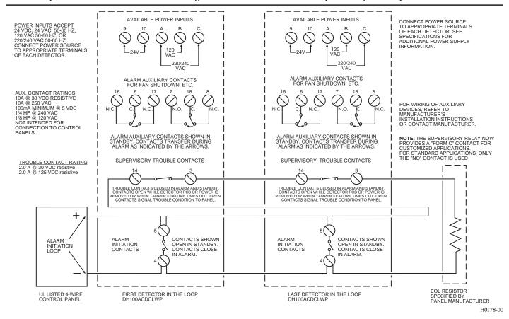
Figure 8. Wiring diagram for DH100ACDCLWP to APA451:
